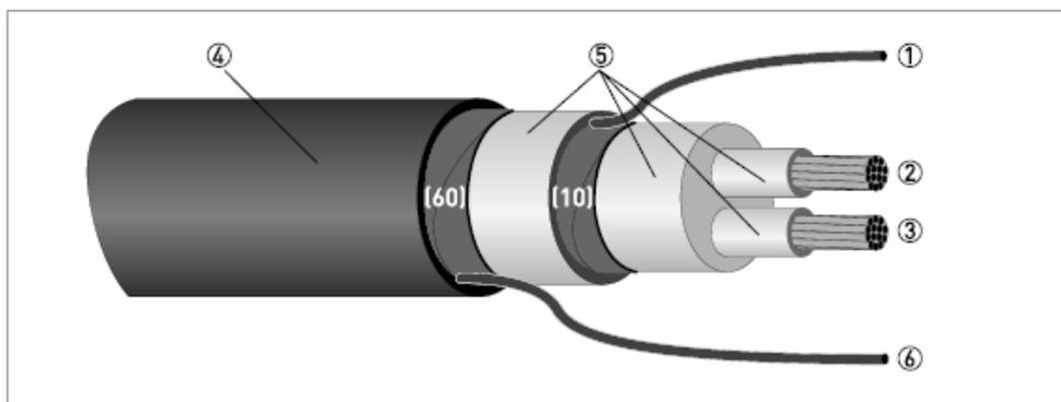
图 4-1: A 型信号电缆的结构
