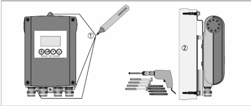
图 3-1: 墙挂型的安装
