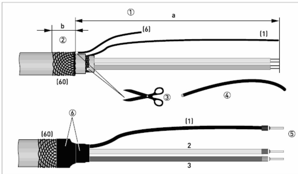
图 4-5: A 型信号电缆的制作，连接到测量传感器
