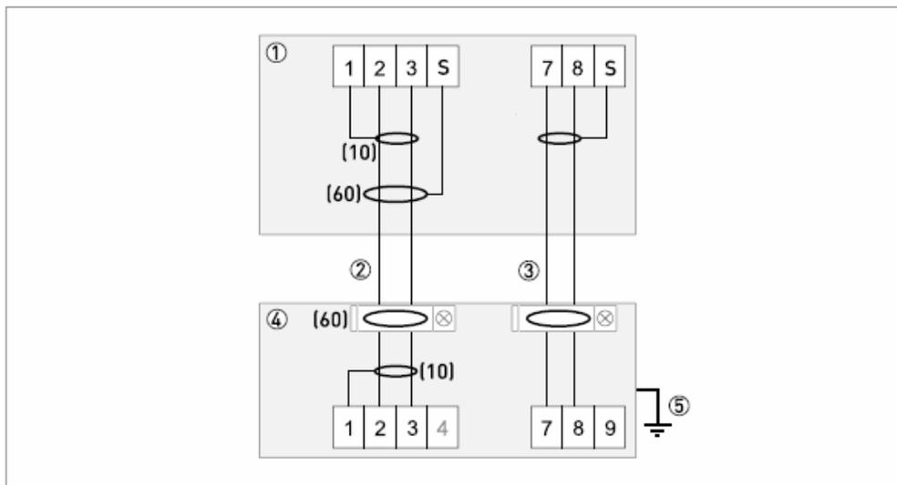
图 4-10：信号电缆和励磁电缆的接线图
