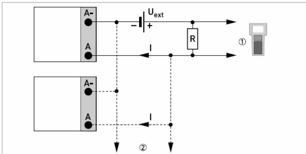
图 4-21: 无源 HART® 连接 ( $I_p$ )
