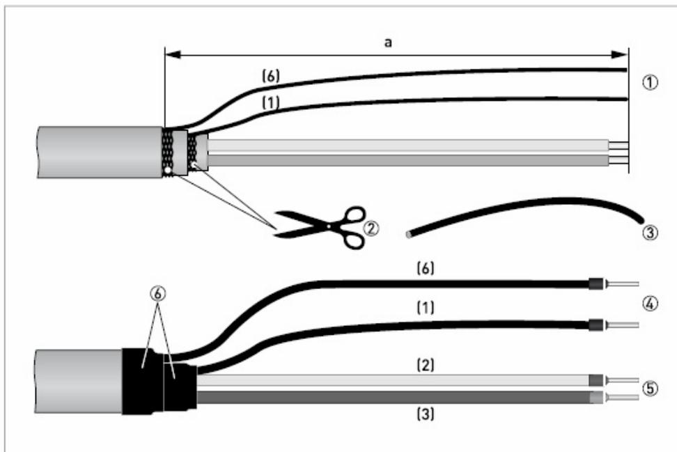
图 4-2: A 型信号电缆的制作
