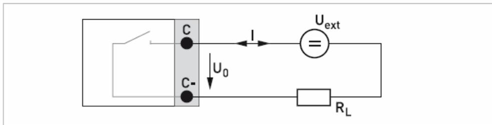
图 4-19: 无源状态输出/限位开关  $S_p$
