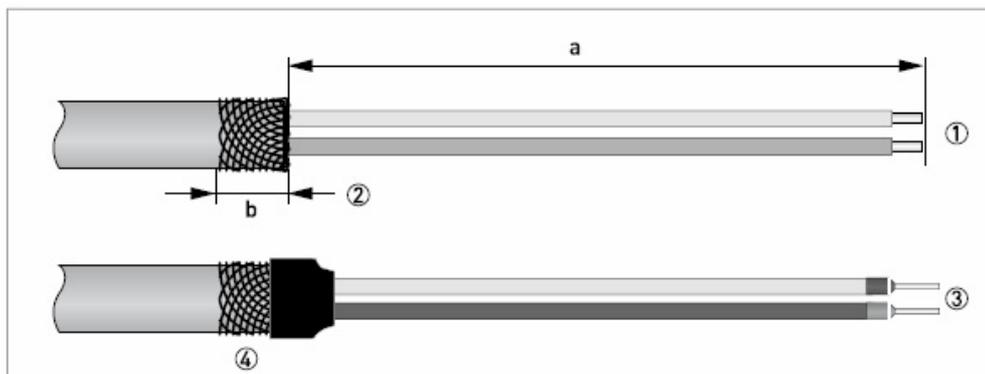
图 4-6: 励磁电缆 C 的制作
