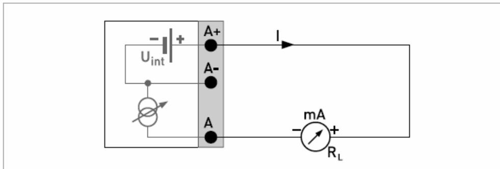
图 4-16: 有源电流输出  $I_a$
