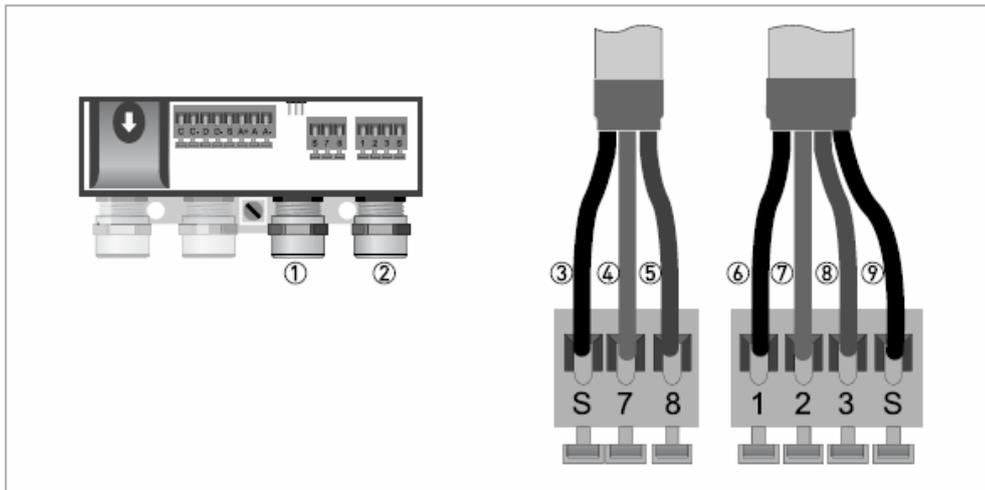
图 4-9：连接信号电缆和励磁电缆
