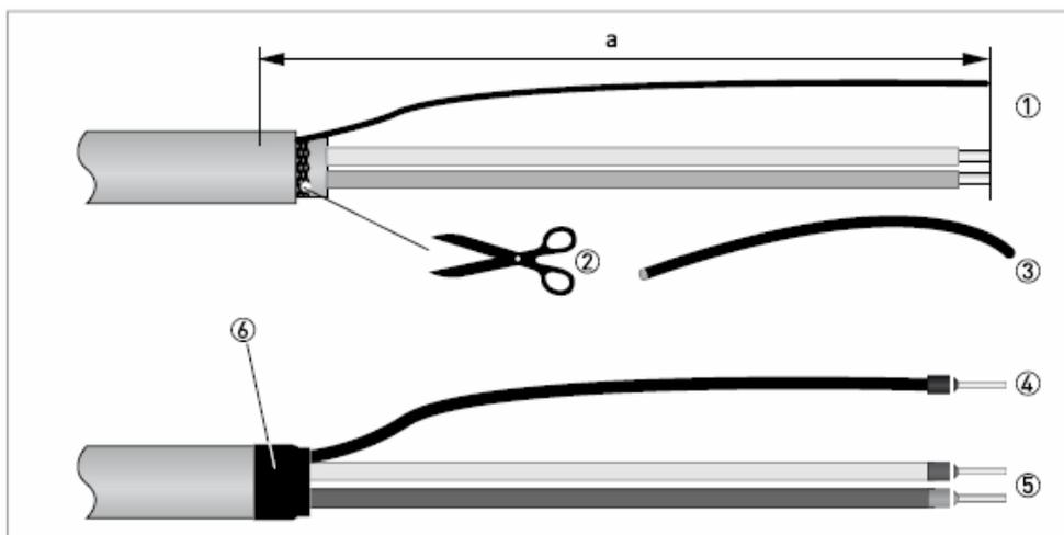
图 4-4: 励磁电缆 C 的制作, 连接到信号转换器
