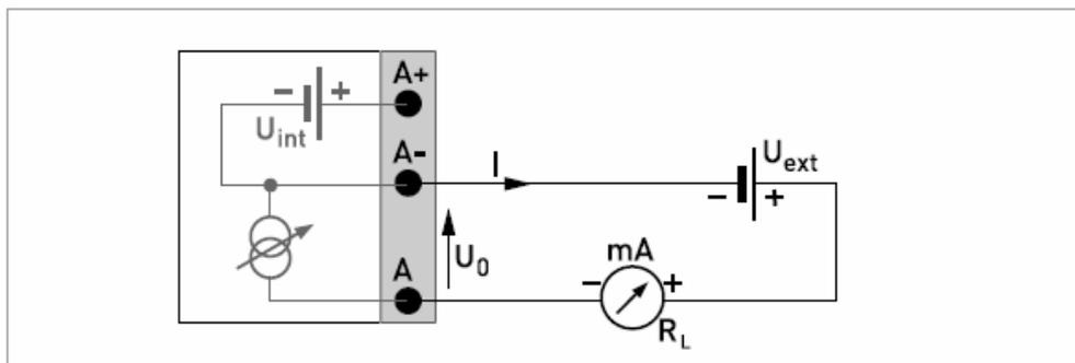
图 4-17: 无源电流输出  $I_p$
