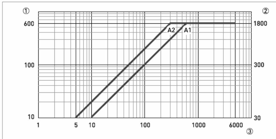
图 4-3: A 型信号电缆的最大长度
