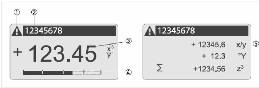
图 6-2：测量模式的显示示例，带 2 或 3 个测量值
