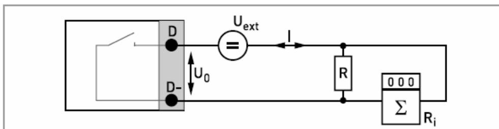
图 4-18: 无源脉冲/频率输出  $P_p$
