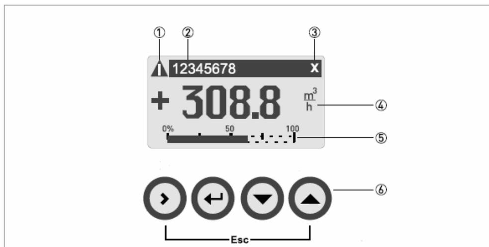
示例：显示和操作按键（示例：带 2 个测量值的流量显示）
